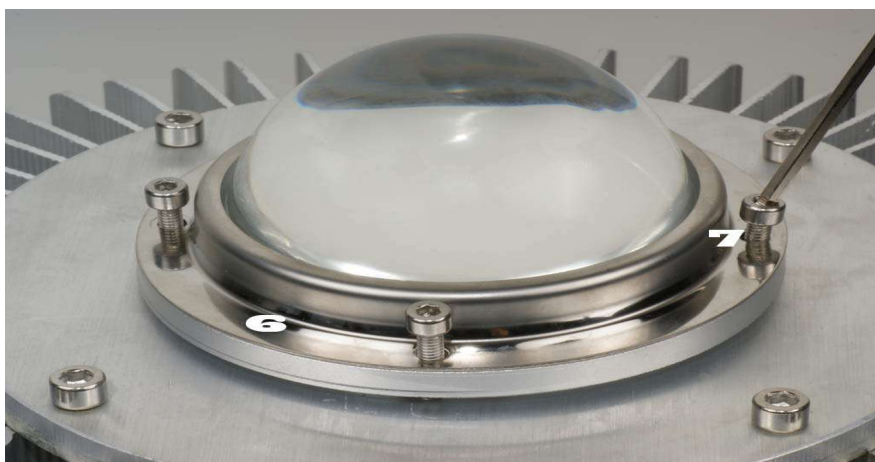
Рис. 2: Выкрутите винты (7) с помощью шестигранного ключа. Стопорное кольцо (6).
