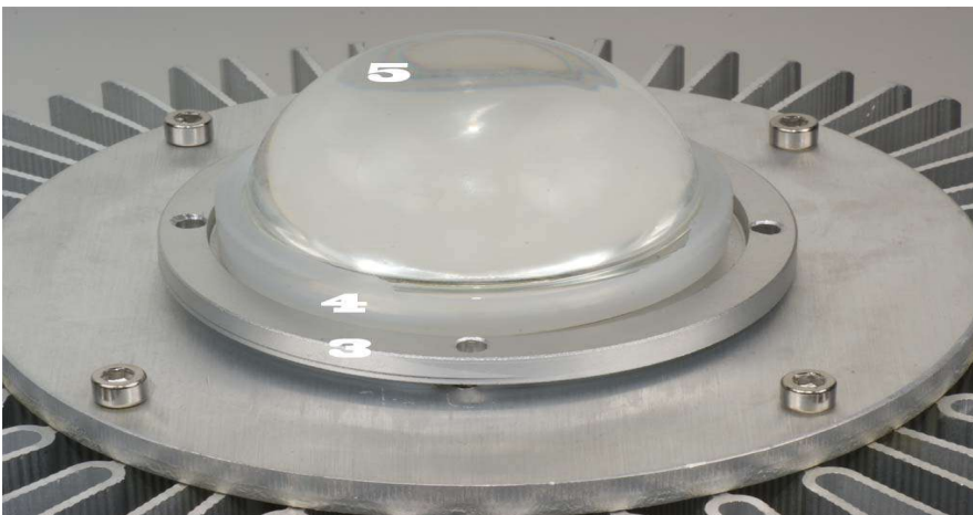
Abb. 3: Aluhalterring (3), Silikonhalterring (4), Linse (5)
